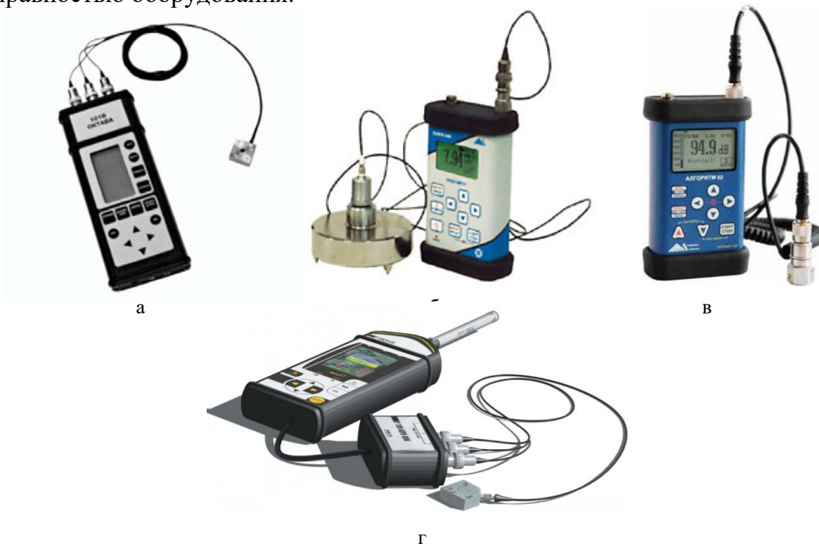
Р и с. 12. Средства проведения измерений уровней вибрации: а – виброметр «Октава110В-3»; б – прецизионный виброметр, анализатор спектра «SVAN-956»; в – виброметр, анализатор спектра «Алгоритм 02»; г – портативная многоканальная система измерения шума, инфра- и ультразвука, локальной и общей вибрации «ЭКОФИЗИКА»
